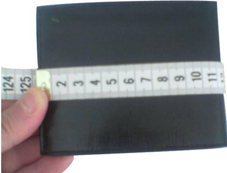
Resim 3.7: Ön gövde ve arka gövdenin ölçüsünün alınması
