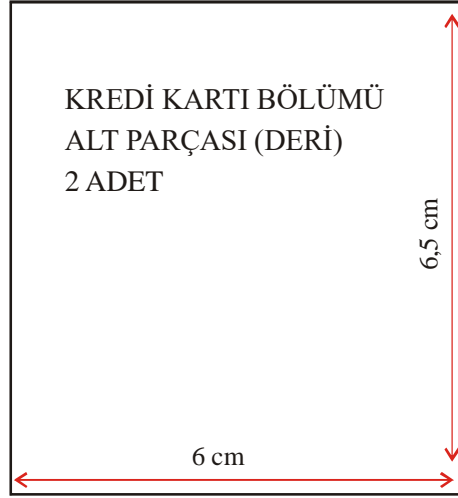
Çizim 2.5: Kredi kartı bölmelerinin alt kısmının kalıp çizimi
