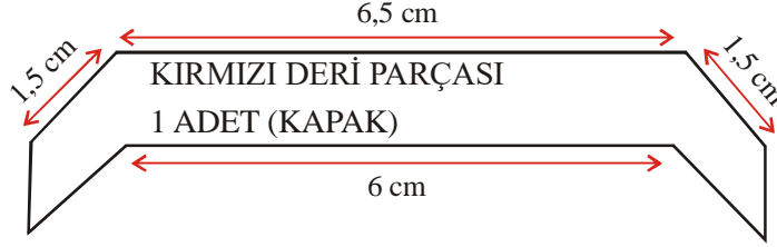
Çizim 1.3: Kırmızı deri parçasının kalıp çizimi
