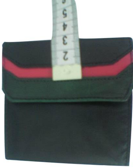
Resim 1.19: Kırmızı deri parçasının ölçüsünün alınması
