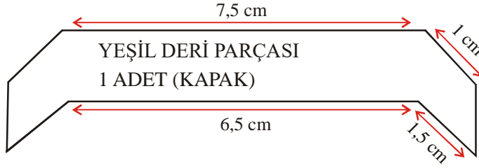
Çizim 1.4: Yeşil deri parçasının kalıp çizimi
